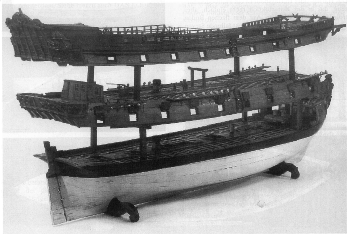
Abb. 2: Dieses Modell kann in drei Horizontaltteile zerlegt werden, womit van Zwijndregt seine neue Baumethode demonstrieren wollte.
