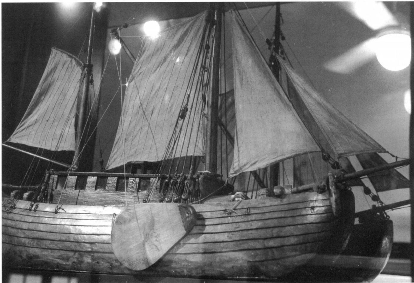
Abb. 1: Gesamtansicht des Modells. Elegant ist der Decksprung, über die gesamte Schiffslänge erkennbar. Das Deck ist nicht wie bei Herman (Abb. 10) im Mittelteil durchgehend gerade.
