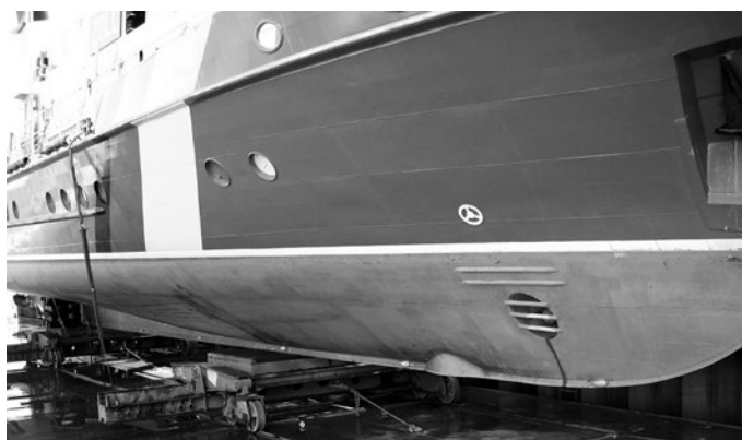
Abb. 4: Bugstrahlruder und Echolot. (Foto: Werftaufsicht, 2009)
