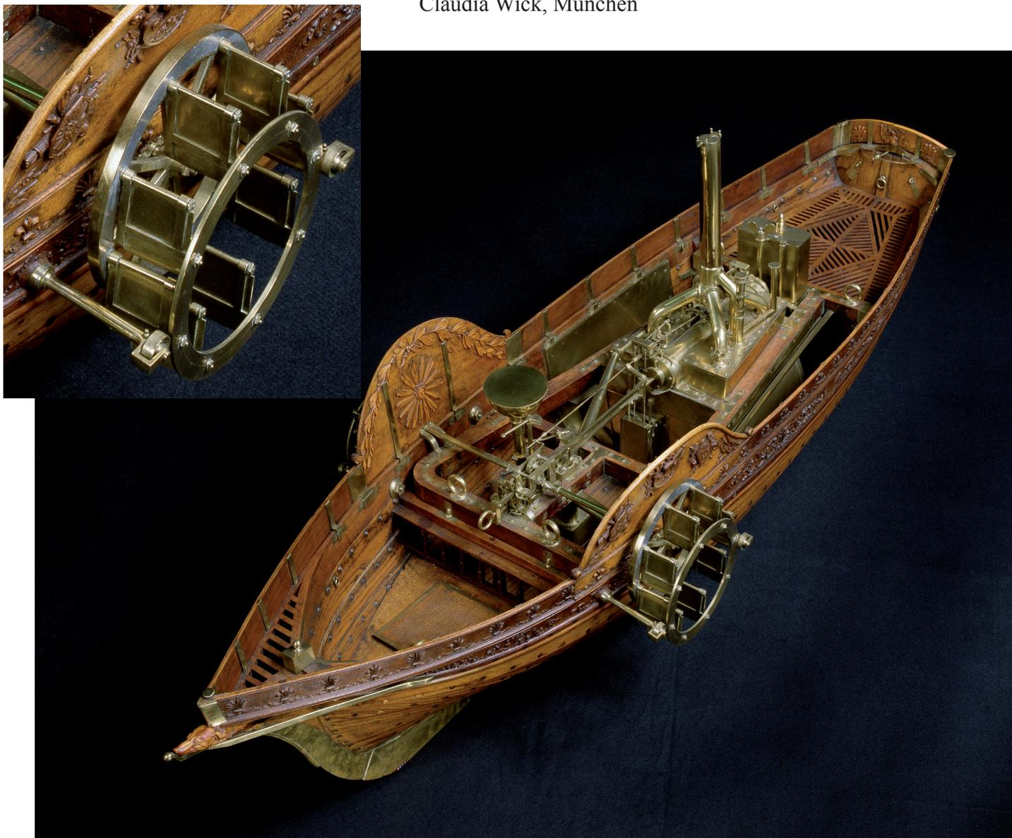
Abb. 1: Modell mit funktionsfähiger Dampfmaschine und beweglichen Schaufeln, erbaut 1801/2 von Claude de Jouffroy d'Abbans.
