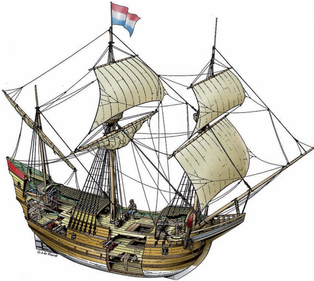
Abb.1: Arbeitsstudie des Expeditionsschiffes von Willem Barentsz. Rekonstruktion und Zeichnung: © Gerald A. de Weerd 2010
