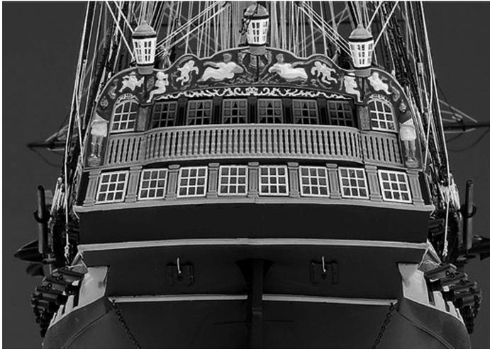
Abb. 2: Heckansicht eines Baukastenmodelles. Hier ist deutlich zu sehen, dass die Seitenfiguren, bedingt durch die Vorgabe des Baukastens, hinten auf die Heckspiegelplatte aufgesetzt wurden. Dadurch verliert das Modell an Kontur im Heckbereich. Ungeachtet der Fähigkeiten des Modellbauers, erscheint diese Partie am Modell sehr plump und grobschlächtig.
