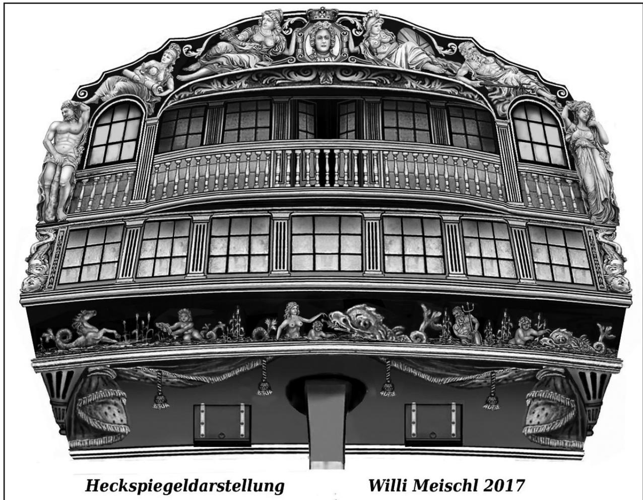
Abb. 1: Das Heck eines 64 Kanonenschiffes um 1770. An diesem Bild zeigt der Autor wie die Gestaltung eines Heckspiegels aussehen sollte. Die Figuren und Schiffskonstruktion bilden eine in sich geschlossenen Einheit.
