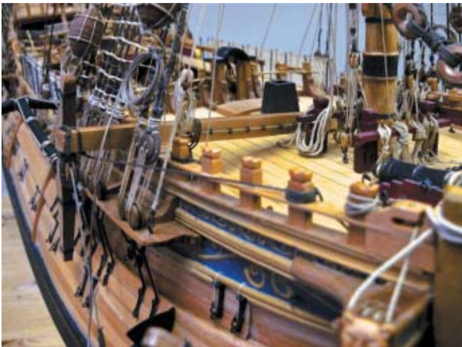
Abb. 2: Blick auf die Back, von Steuerbord Bug aus gesehen. Sehr schön zu sehen: Der voll ausgerüstete Penterbalken.
