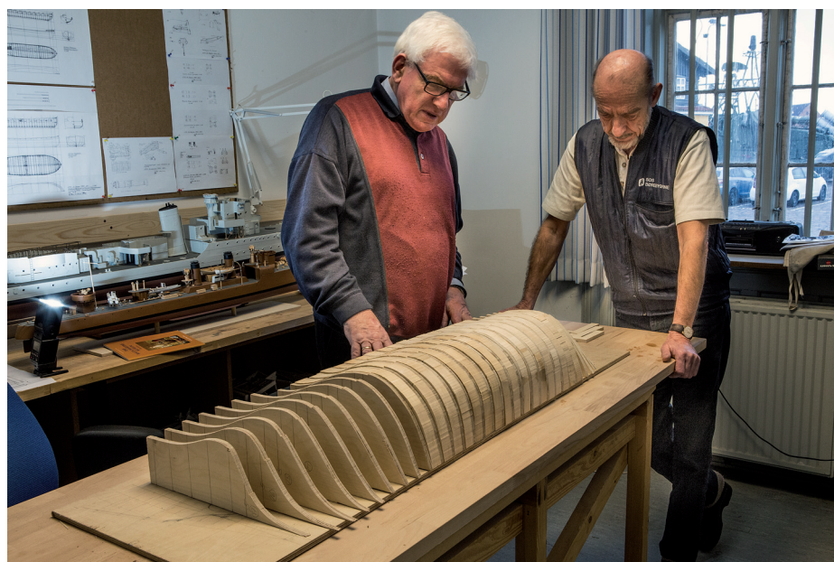
Abb. 3: Vorsitzender Poul Beck (links) und der zweite Vorsitzende Niels Buhl mit den ausgesägten Spanten für das Modell der ST. GEORGE am 28.02.2017 in der Werkstatt der Innung in Kopenhagen. Foto: Steffen Ortmann/ Modellbauer-Innung
