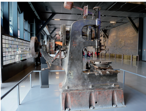
Abb. 10: Fräsmaschine der Firma Ducomm aus Mühlhausen aus dem Jahr 1867 mit Rundtisch. Foto: Autor.
