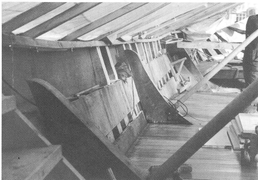
Deck und Bordwand der Kogge, mit Wegerplanken und den Schenkeln der Seitenkniee.
