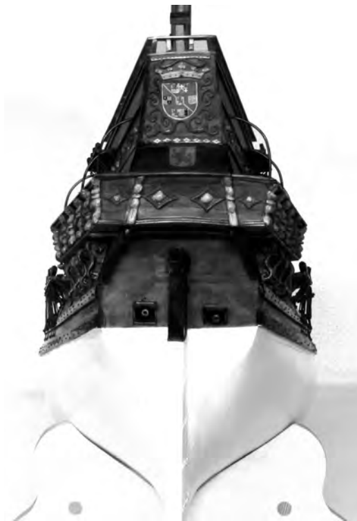
Abb. 15: Ansicht von achtern mit Spiegel, Galerie und Hackbord. Die Abbildung auf dem Hackbord ist reliefartig geschnitzt nach einer Darstellung (Bemalung) der Stadt Amsterdam von Pieter Isaakz, die sich auf der Innenseite des Deckels einer Klavierzimbel befindet, gefertigt in der ersten Dekade des 17. Jahrhunderts.
